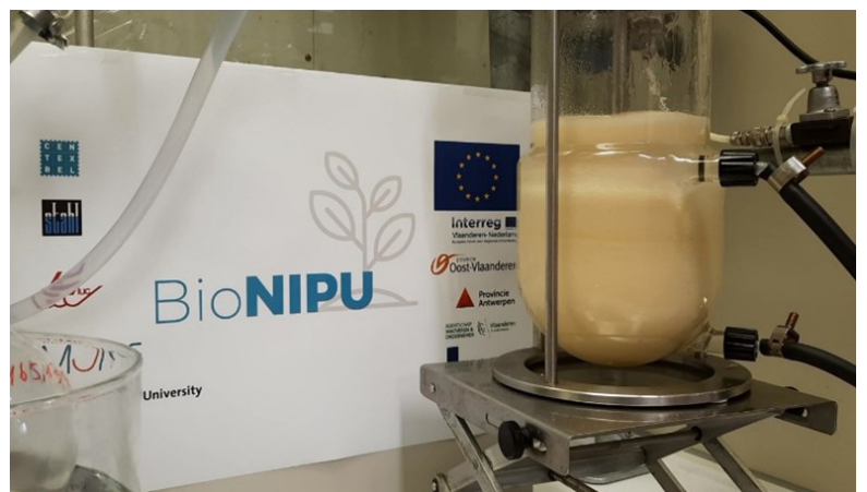
Fig. 2: opgeschaalde watergebaseerde NIPU dispersie voor coatings
